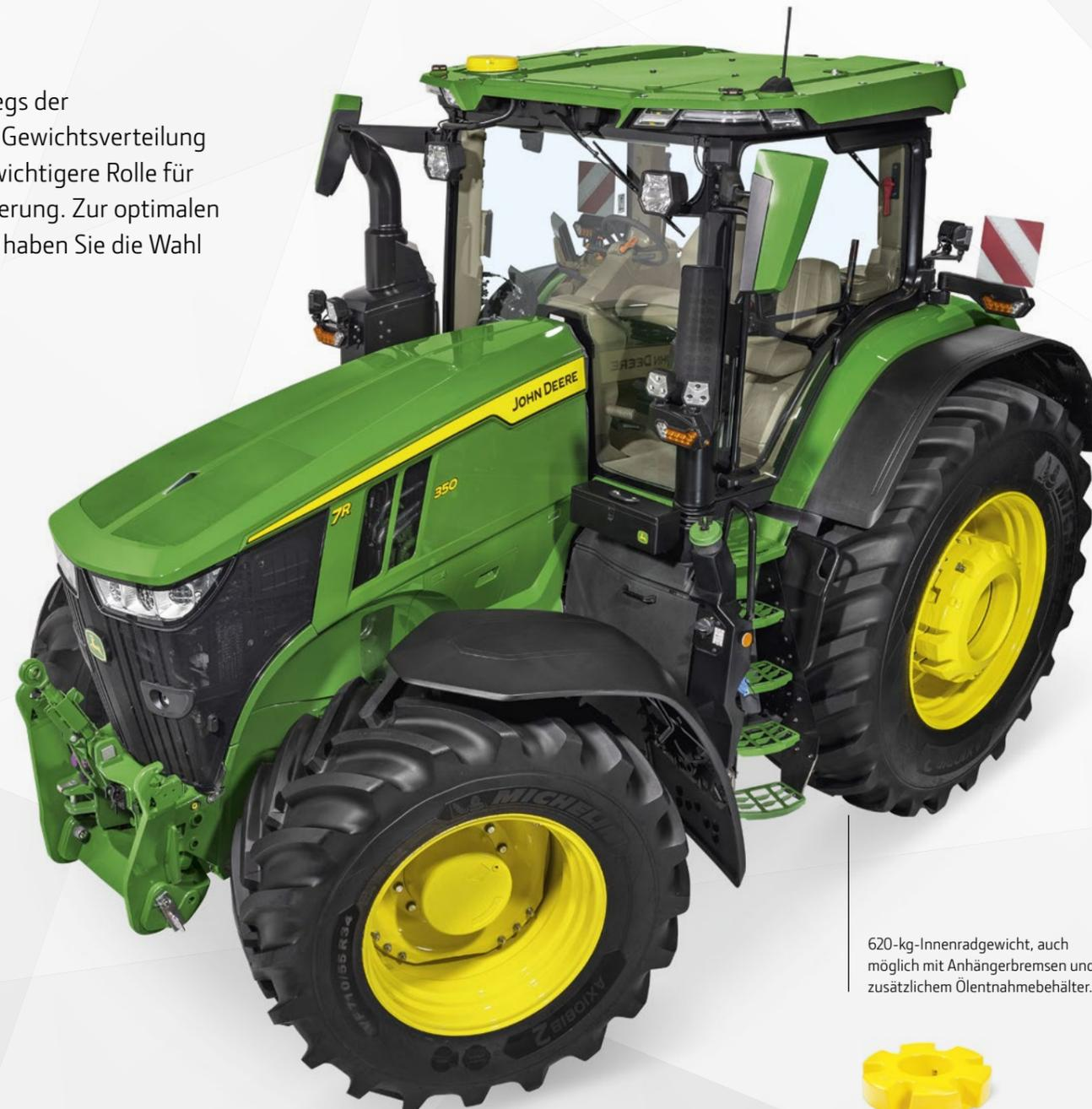
620-kg-Innenradgewicht, auch möglich mit Anhängerbremsen und zusätzlichem Ölentnahmebehälter.
