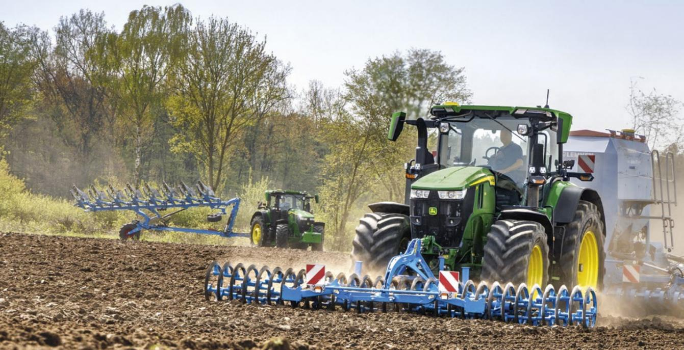
Der optional erhältliche iTEC™-kompatible Frontkraftheber erreicht eine konstante Hubleistung von 3.500 kg an der Fronthydraulik
