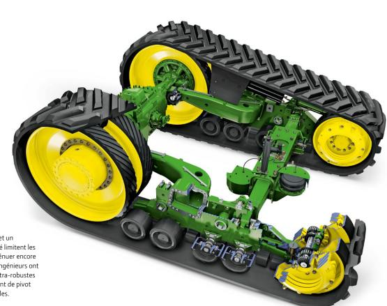
Deux coussins d'air et un amortisseur renforcé limitent les secousses. Pour atténuer encore plus les chocs, nos ingénieurs ont prévu des bagues ultra-robustes faisant office de point de pivot pour les deux chenilles.
